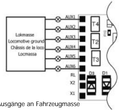
Anschluss der Ausgänge an Fahrzeugmasse
