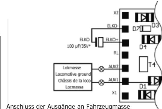
Anschluss der Ausgänge an Fahrzeugmasse
